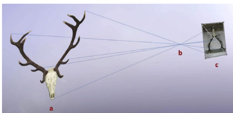
Fig. 3. Trayectoria de la incidencia de rayos sobre el plano de la fotografía. a) Objeto real. b) Posición de la lente de la cámara. c) Fotografía (a escala reducida e invertida).
