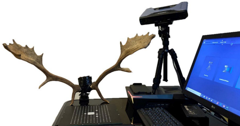
Fig. 16. Escáner de EinScan Pro 2X en laboratorio sobre trípode, previo a la toma de datos.
