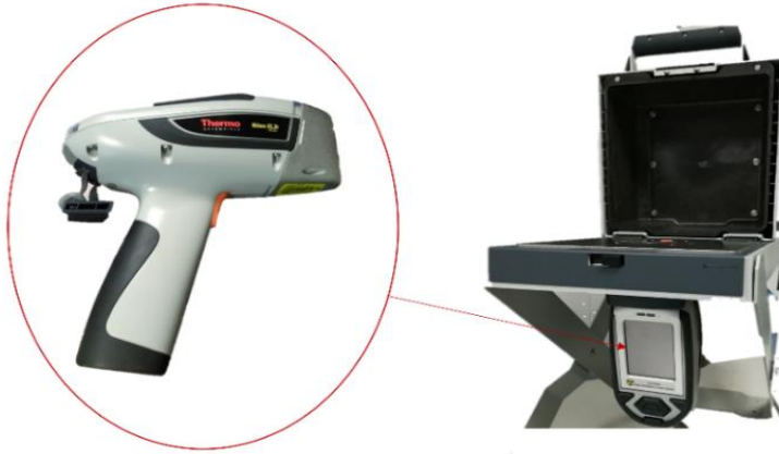
Figura 40. Analizador portátil de fluorescencia de Rayos X de dispersión de energías XL3t GOLDD+ (Niton) del grupo de investigación FQM-363 de la Universidad de Jaén y su posición cuando se coloca en el stand de plomo.
