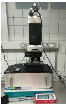
Figura 35. Microespectroscopio Raman confocal alpha300 RSA+ (WITec) de la Universidad técnica de Viena
