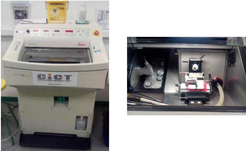
Figura 28. Criostato CM 1950 (Leica) del CICT de la Universidad de Jaén y detalle del cabezal, cuchilla y zona de trabajo durante el corte transversal de una lámina de grosor 40\ \mu\text{m}
