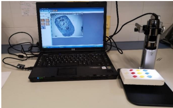
Figura 37. Microscopio óptico digital (Dino Lite) del grupo de investigación FQM-363 de la Universidad de Jaén
