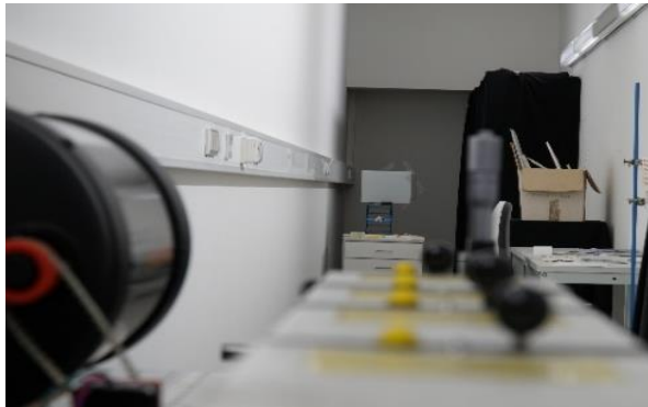
Figura 31. Detalle de la distancia de separación entre el telescopio y la muestra durante una medida de espectroscopía Raman a distancia
