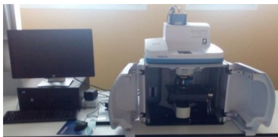
Figura 34. Microespectroscopio Raman confocal XploRA-Plus (HORIBA) temporalmente disponible en el CICT de la Universidad de Jaén
