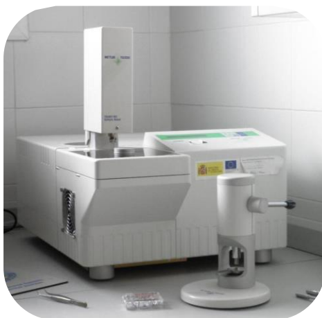
Figura 4.4.7. Equipo DSC Mettler Toledo. Fuente: Universidad de Jaén.
