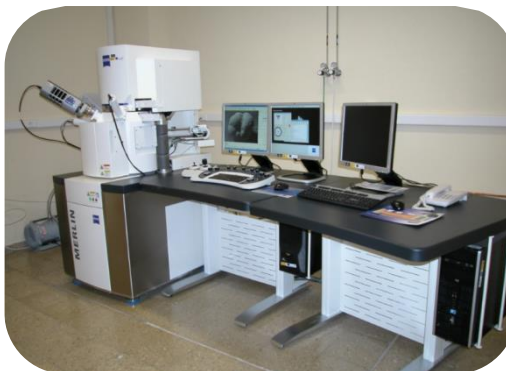
Figura 4.4.10. Equipo de microscopía electrónica de barrido. Fuente: Universidad de Jaén.
