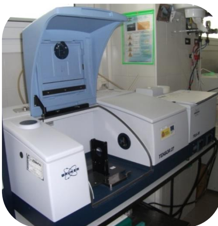
Figura 4.4.12. Espectrómetro FT-IR Bruker Tensor 27. Fuente: Universidad de Jaén.
