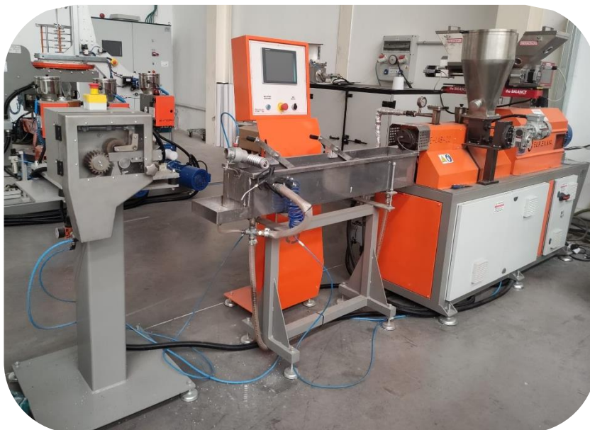
Figura 4.3.1. Línea de extrusión-peletizado Mini E-Lab 22.
