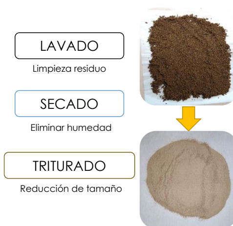
Figura 4.2.12. Esquema acondicionamiento hueso de aceituna.
