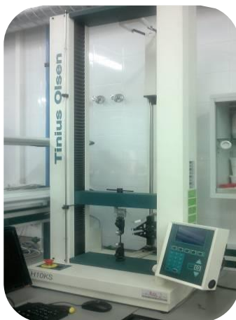
Figura 4.4.2. Máquina Universal de Ensayos Tinius Olsen 10KS. Fuente: Centro Tecnológico Andaltec.
