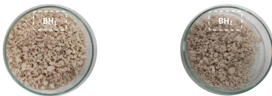
Figura 5.1.7. Fibras OTP-AH tras los tratamientos alcalinos (BH).
