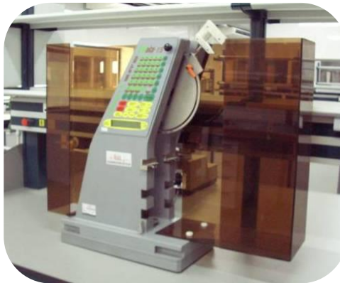
Figura 4.4.5. Impactómetro de péndulo Charpy – Izod IMPats 2281. Fuente: Centro Tecnológico Andaltec.
