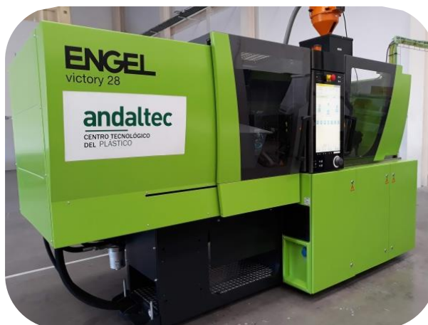
Figura 4.3.5. Inyectora ENGEL Victory 28.
