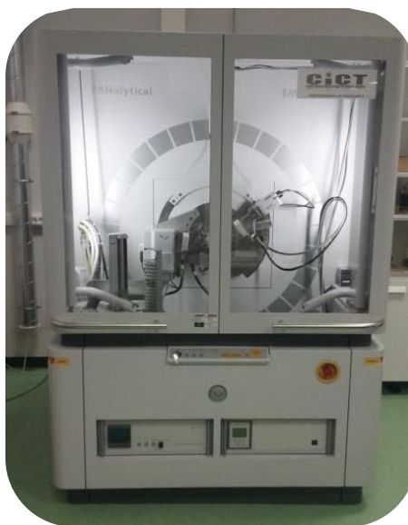
Figura 4.4.13. Difractómetro Empyrean PANalytical. Fuente: Universidad de Jaén.
