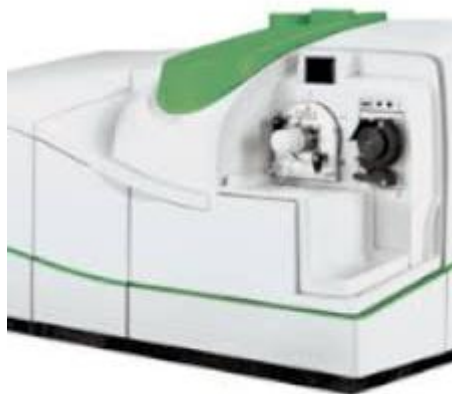
Figura 4.18. Espectrómetro de masas de alta resolución con plasma de acoplamiento inductivo (HR-ICP-MS) modelo ELEMENT XR.
