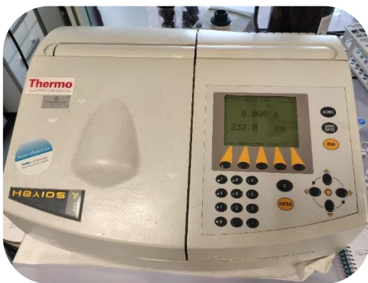
Figura 4.8. Espectrofotómetro Thermo Spectronic Helios Gamma 9423 UVG 1000E UV.
