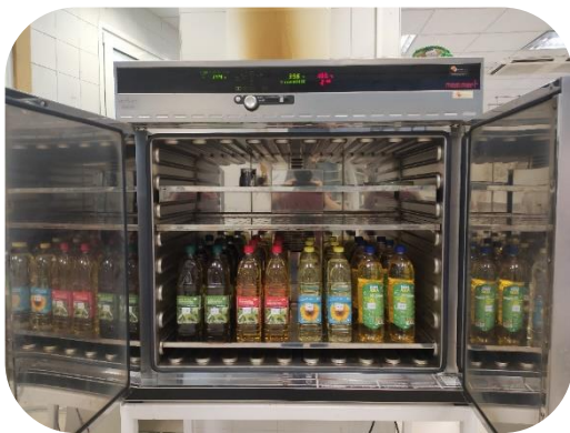
Figura 4.6. Estufa Memmert. En el interior está en proceso el tratamiento de las muestras correspondientes al Estudio B, a 40 °C.
