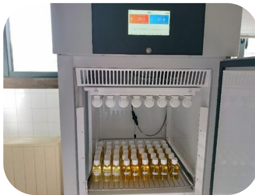
Figura 4.7. Cámara climática Aralab. En el interior está en proceso el tratamiento de las muestras correspondientes al Estudio C, a 20 °C.
