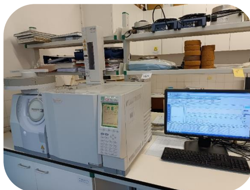
Figura 4.16. Cromatógrafo de gases-masas GC/MS Shimadzu GCMS-QP2010 SE.
