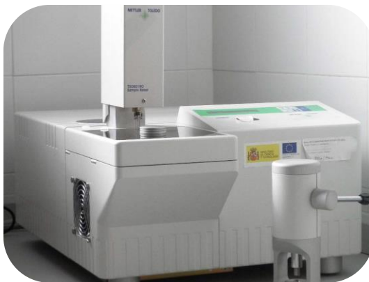
Figura 4.13. Calorímetro Diferencial de Barrido (DSC), modelo 822e de Mettler Toledo. Fuente: AT03-Calorímetro diferencial, Servicios SCAI de la Universidad de Jaén.
