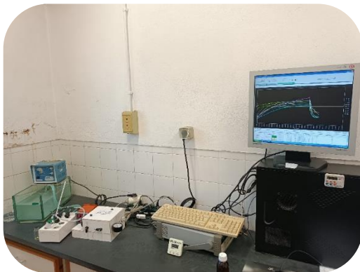
Figura 4.14. Dispositivo de Nariz Electrónica (fabricado en laboratorio).
