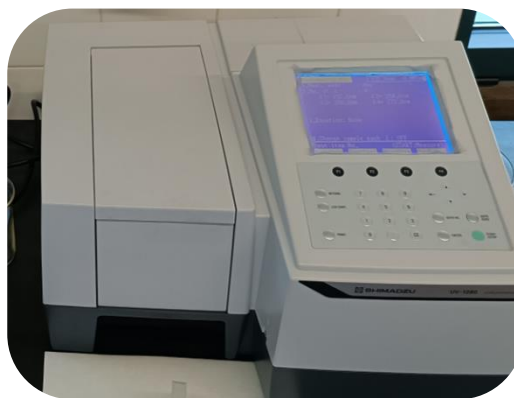
Figura 4.9. Espectrofotómetro UV-1280 Shimadzu.
