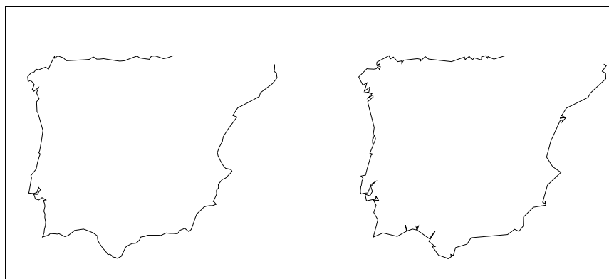
Figura II. 18: Comparación de generalización realizada con algoritmo de Visvalingam (izda.) y con algoritmo de Douglas-Peucker (dcha.)
