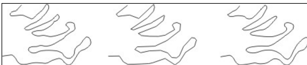
Figura II. 43: Compresión datos originales (izquierda) mediante Douglas-Peucker (centro) y representación B-spline (derecha)
