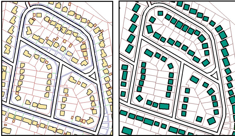
Figura II.15: Generalización de edificios mediante software Clarity
