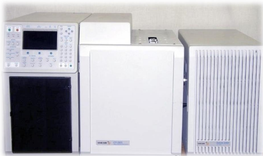
Figura III.2. Sistema cromatográfico de GC-MS (Varian 2000).
