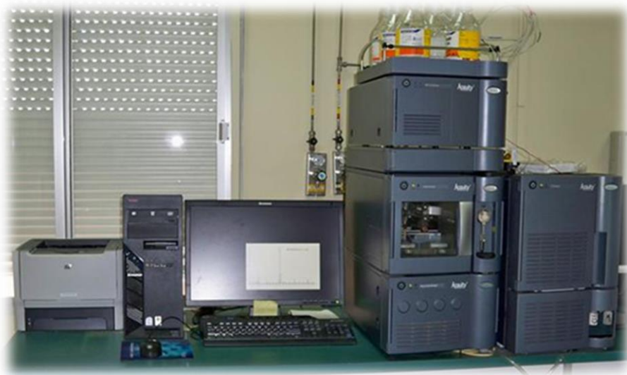
Figura III.1. Sistema cromatográfico UPLC-MS/MS ( Waters Acquity , Reino Unido).
