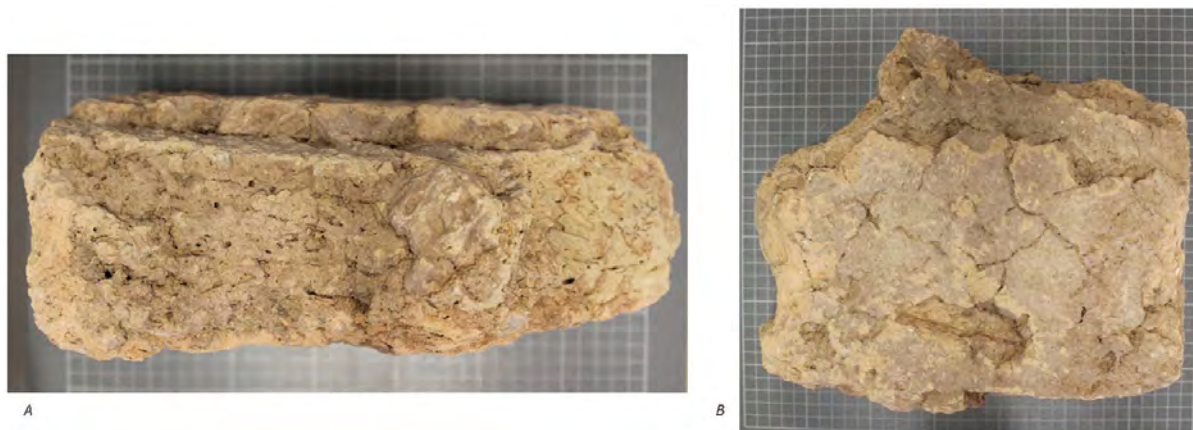
Fig. 204 Ladrillo G14-11119-1 que conserva restos de argamasa adheridos lateralmente. A) Detalle de la argamasa en el lateral. B) Vista cenital.
