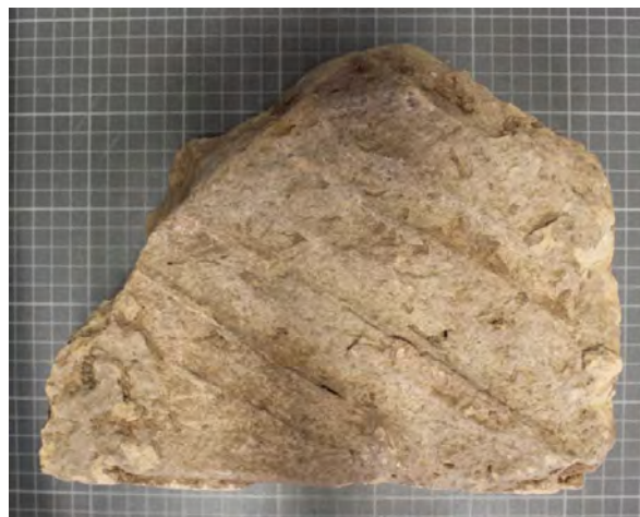
FIG. 192 Ladrillo G14-11074-6 en el que se aprecian cuatro digitaciones.
