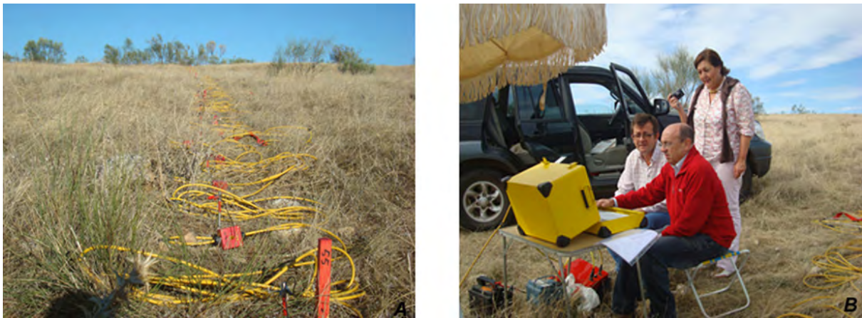
FIG. 46 A) Electrodo ubicados sobre la superficie del terreno. B) Equipo de medida.
