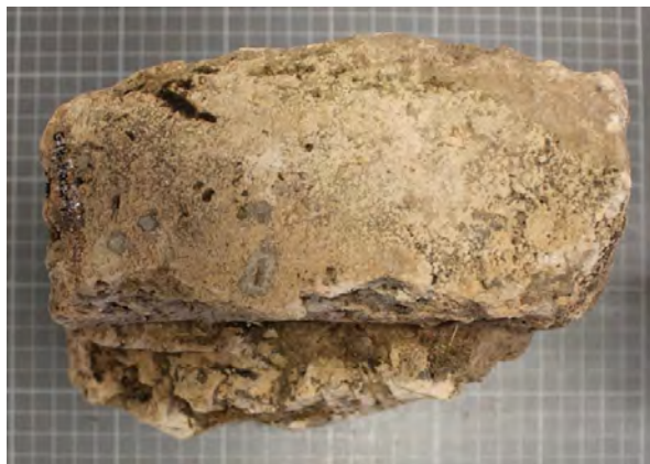
Fig. 200 Fragmento de ladrillo G14-11017-4, que aún conserva restos de argamasa adherida a su superficie.
