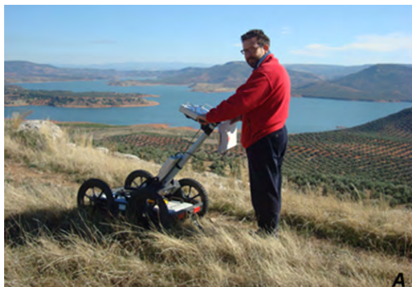
FIG. 48 Equipo utilizado para la prospección con Georradar. A) Sistema RAMAC/GPR. B) Estaquillado.
