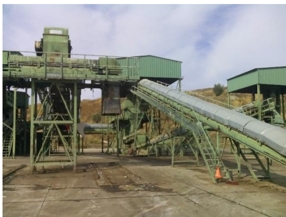
Figura 24. Cinta transportadora que guía a los residuos, una vez extraída la fracción férrica, hacia la planta de compostaje.
