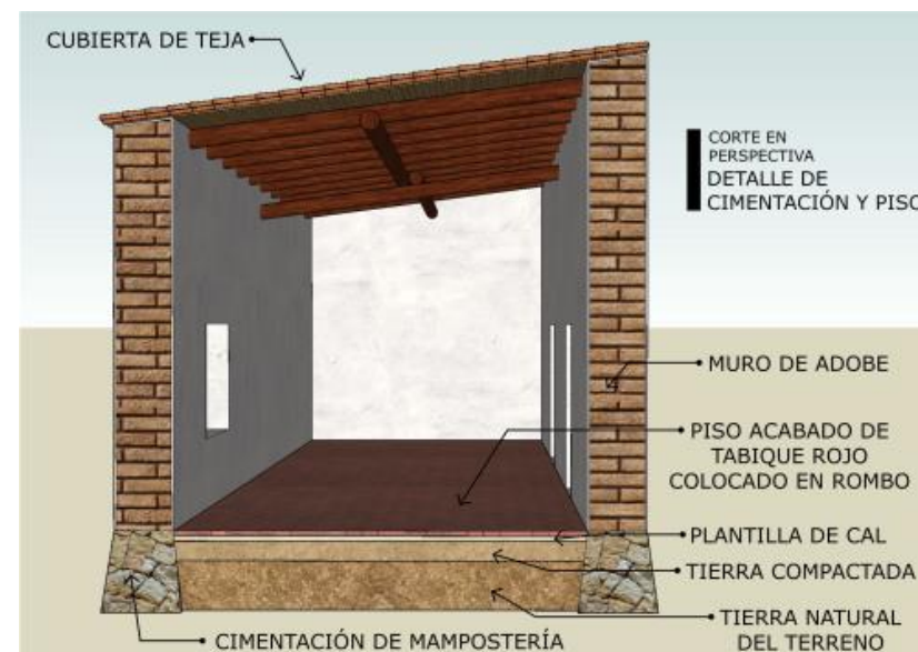
Imagen 226.- Detalles de cimentación y pisos Autor Jorge Porras A.
