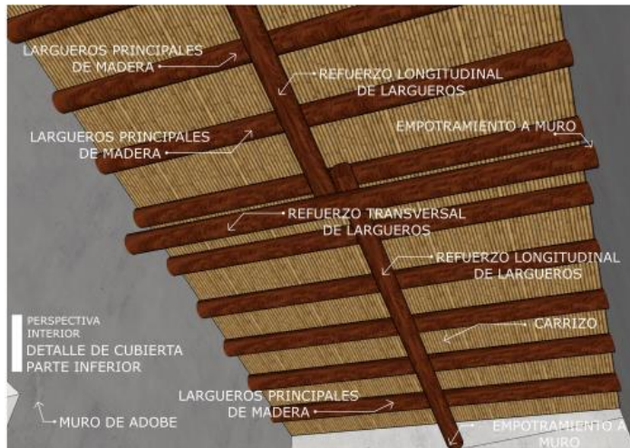
Imagen 229.- Detalle de cubierta. Autor Jorge Porras A.
