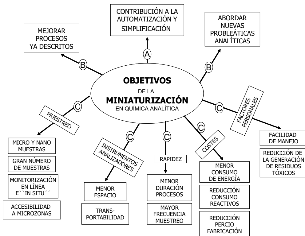
Fig. I.16. Objetivos genéricos (A), básicos (B) y específicos (C) que pueden alcanzarse al miniaturizar herramientas y procesos analíticos.
