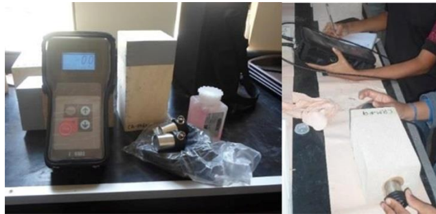
Figura 4.2. Proceso para el desarrollo de pruebas de pulso ultrasónico.
