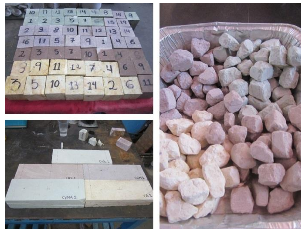
Figura 5.8. Especímenes para el desarrollo experimental: a) cubos b) losas c) fragmentos.
