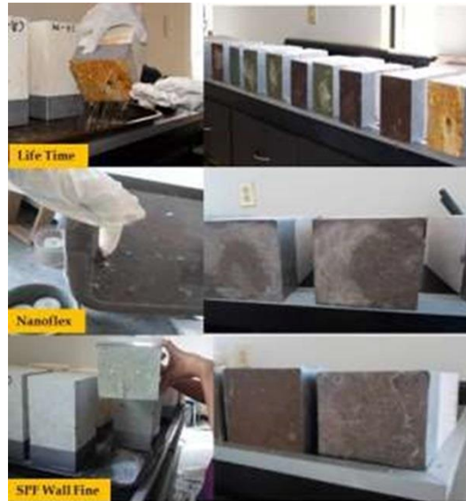
Figura 4.4. Especímenes después de la aplicación de los recubrimientos— Método de absorción.
