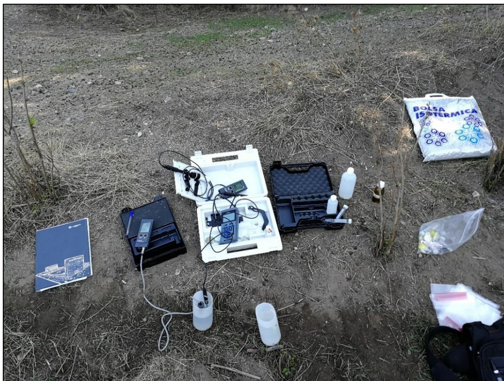
Figura 23: Medidas in situ en los puntos de muestreo de aguas
