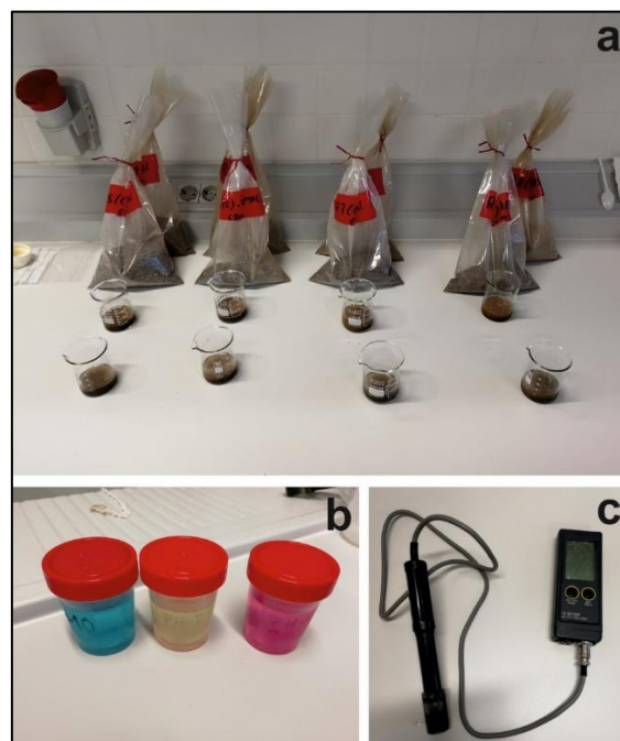
Figura 19: Procedimiento para determinar el pH en suelos
