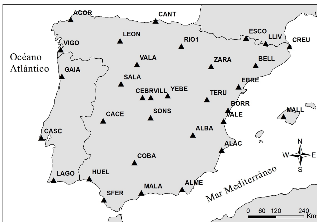
Figura 7.5: Distribución geográfica de las estaciones de la red EUREF en la Península Ibérica y Baleares
